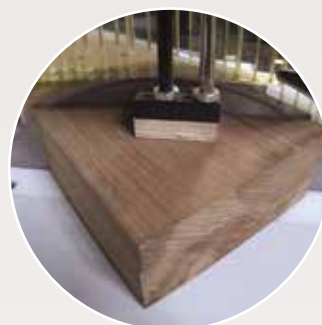
Sistema di bloccaggio pezzo con pressori verticali pneumatici Workpiece clamping system with pneumatic vertical clamps Système de verrouillage de pièces avec verins presseurs pneumatiques Sistema de bloqueo pieza con prensos verticales neumáticos
