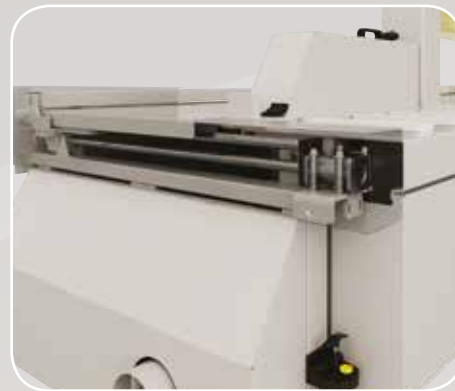
Posizionamento spintore frontale con viti a ricircolo di sfere Positioning of front pusher with recirculating ball screws Positionnement du guide avec vis à recirculation de billes Posicionamiento del empujador con tornillos recirculación de bolas
